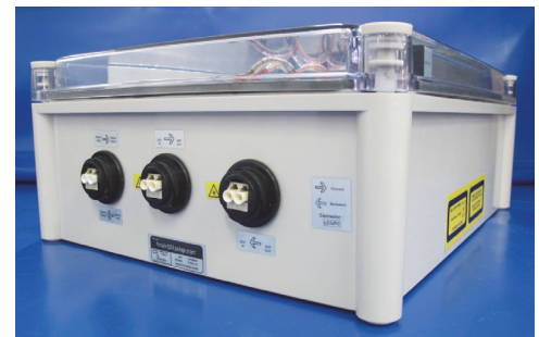
図4 可搬型EDFA実証機
