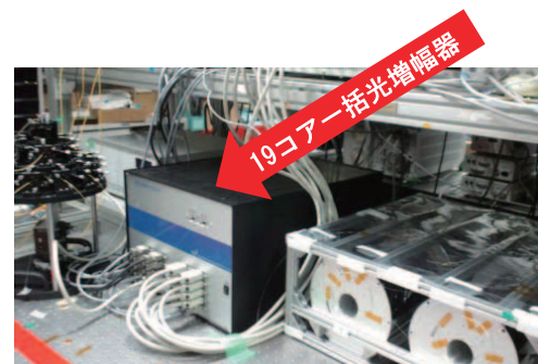
図2 19 コア一括光増幅器を利用した伝送実験
