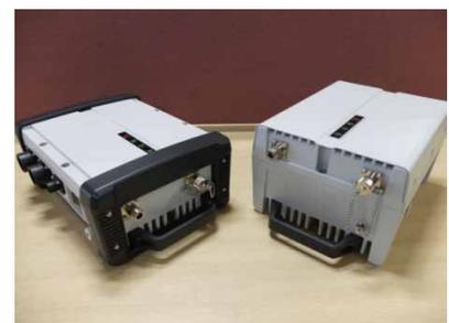
図 1 左: Wi-SUN 無線機と、搭載されている無線モジュール
