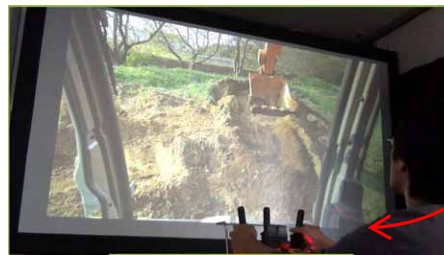
図6 臨場感の伝達による建設機械の遠隔操作性実験システム
