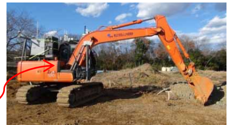
図6 臨場感の伝達による建設機械の遠隔操作性実験システム
