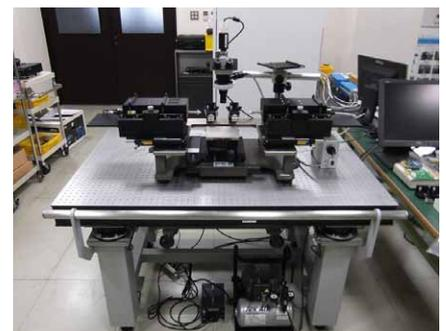
図 2 整備した導波管部品及びオンウエハ・プロービング計測環境
