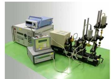
図 3 世界初の D バンド電力校正システム
