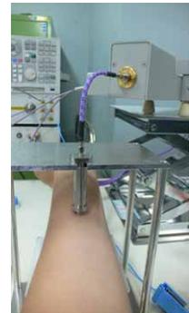
図 2 同軸プローブを用いたミリ波帯電気定数測定系
