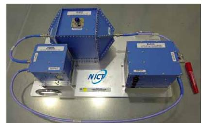
図 1 TEM セルを用いた広帯域伝導妨害測定装置
