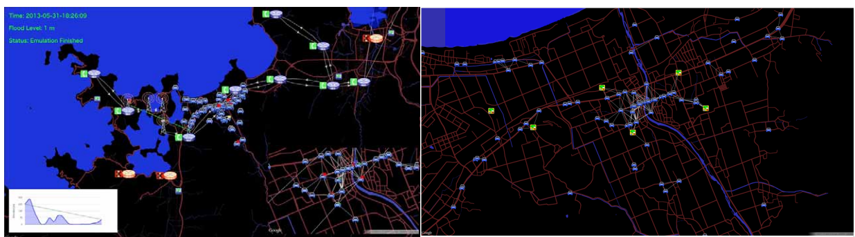
図4 災害シナリオに基づいたエミュレーションとその可視化 左: 全体像、右: 車車間エミュレーション部分のみ抽出
