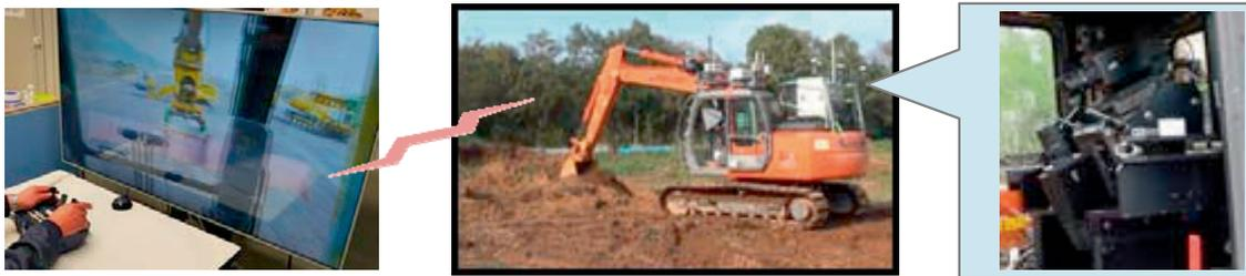
図5 高精細立体(4K3D)映像の伝送による遠隔作業の作業効率の向上効果を検証するための実験
