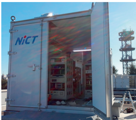
図1 風と \text{CO}_2 の分布観測実証実験を行うライダーモバイルシステム
