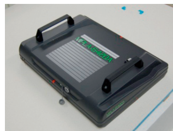
図 5 20GHz までのマイクロ波を使ったアレイ型レーダの試作機
