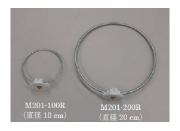
周波数 30 MHz 以下で使用する標準ループアンテナ。国家計量標準にトレーサブルなアンテナ校正を可能にする"仲介用"アンテナとして校正機関・試験機関・企業等への利用が可能。
