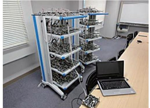
図 3 100 台の FPGA を用いた RFID 認証プロトコルの実装実験
