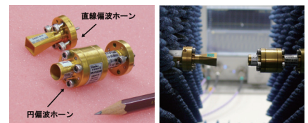
図5 300 GHz帯円偏波ホーンアンテナの校正
