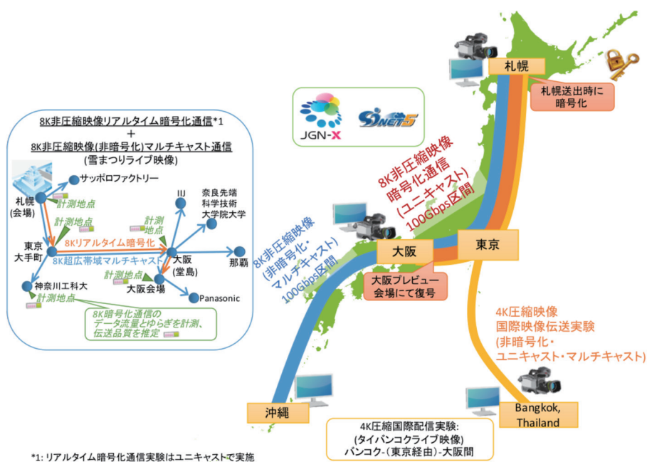
図 4 非圧縮 8 K 映像のリアルタイム暗号化通信の実証実験
