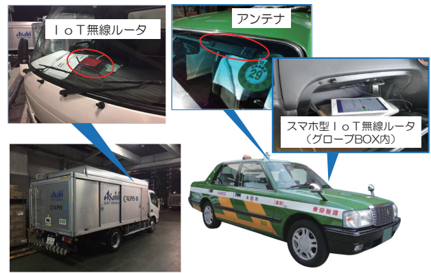
図4 飲料補充車両とタクシーにモバイルIoT無線ルータを実装
