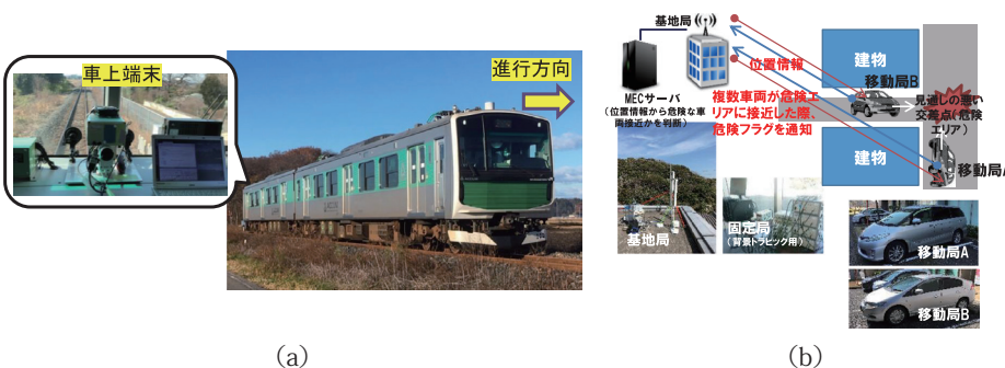
図1 ワイヤレスネットワーク制御・管理技術 (a) プライベートマイクロセル事前仮想接続技術の鉄道無線実証、 (b) MECアプリと連動したSTABLE拡張実証
