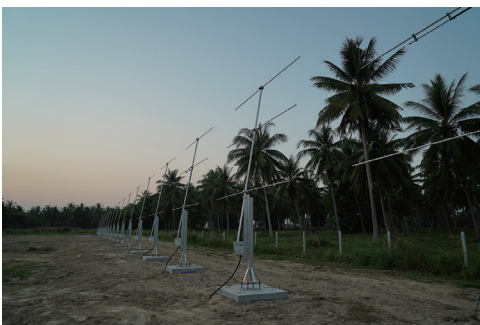
図1 タイ・チュンポンに設置、運用を開始したプラズマバブル観測用VHFレーダ
