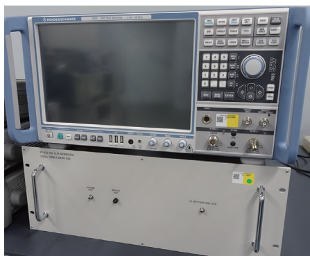
図2 広帯域不要波（スプリアス）に対する高速スペクトル測定装置
