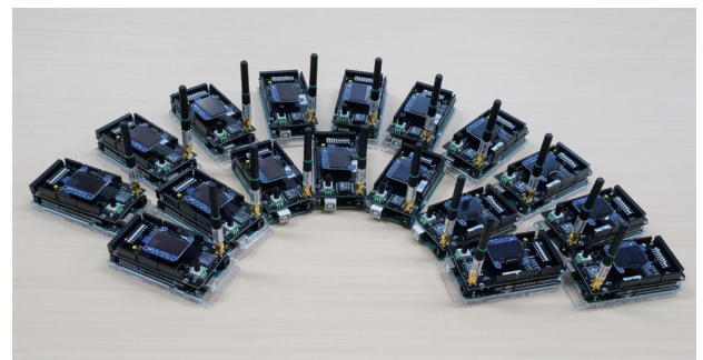
図3 APCMAの基本的なワイヤレス動作を確認するための試作機
