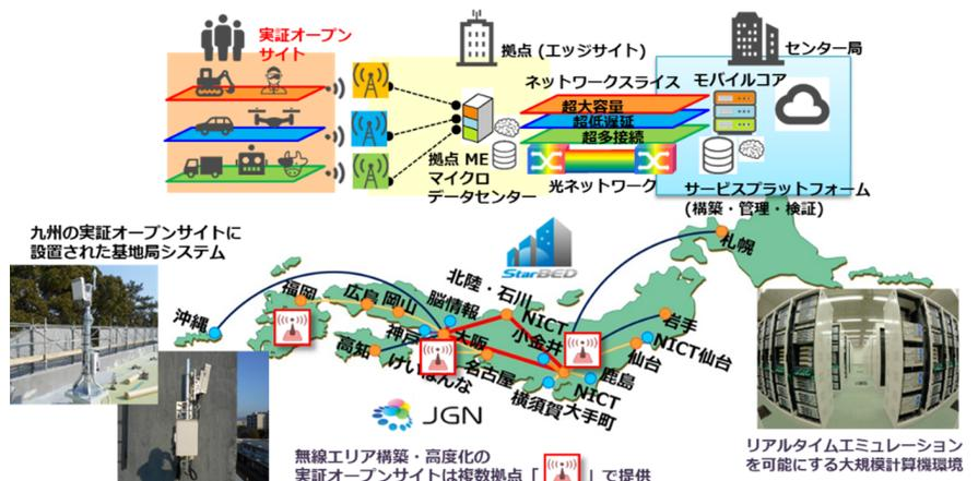
図1 高信頼・高可塑B5G/IoTテストベッドの構成
