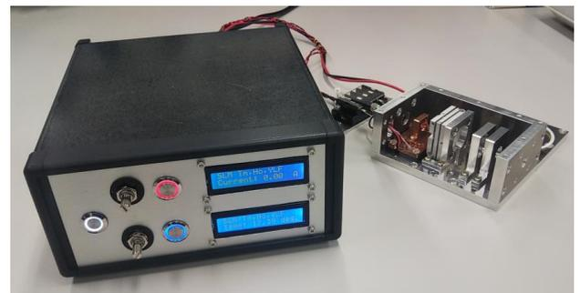
図2 NICTで内製したMP-DIAL用2 μm帯種レーザー
