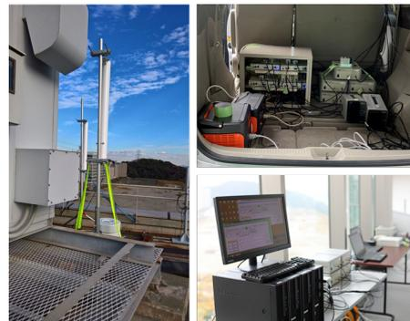
図4 STABLE実験におけるDL送信ダイバーシチアンテナ (左)、車載移動局 (右上)、屋内移動局 (右下)
