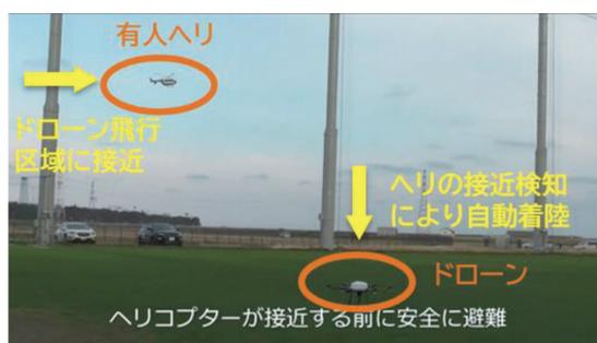
図4 機体間通信を応用した有人ヘリとドローン接近回避技術実験の様子
