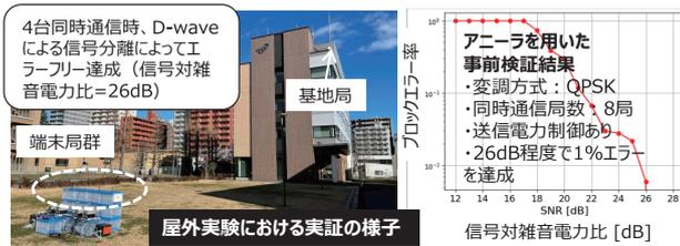
図2 量子アニーリングマシンを用いた信号分離手法の原理検証実験
