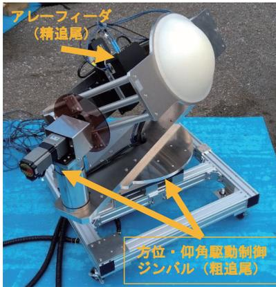
図3 機械的及び電子的な追尾機構によるハイブリッド型追尾レンズアンテナシステム
