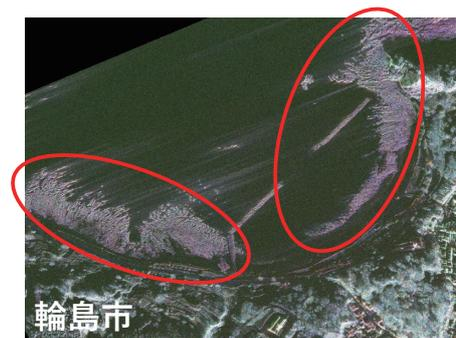
図1 輪島市沿岸の観測データの一例。赤○で示した部分が地震による隆起で海面から出たところ。
