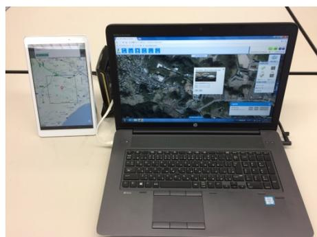
(右) オンプレミスGISが動作しているノートPC。現場で撮影された写真を地図上で表示している様子。
