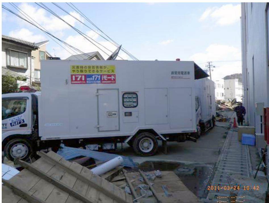
【可搬型通信設備による通信ビル機能の復旧（七ヶ浜ビル）】
