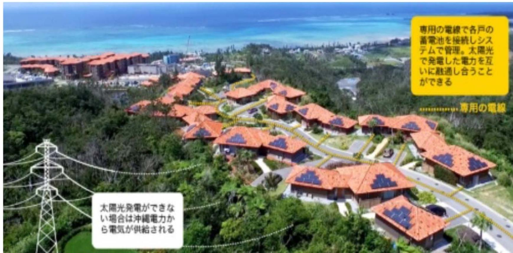
ソニーCSLなどが沖縄で実証実験中のマイクログリッドのイメージと仕組み
