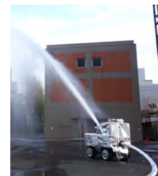
(e) プラント大規模消火ロボ ドラゴンハイパー・コマンドユニット (総務省消防庁)
