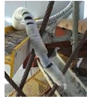
(a) 狭隘箇所点検調査ロボ (福島原発使用)
