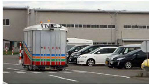
(b) 工場屋外搬送自動化 (トヨタ東日本岩手工場)
