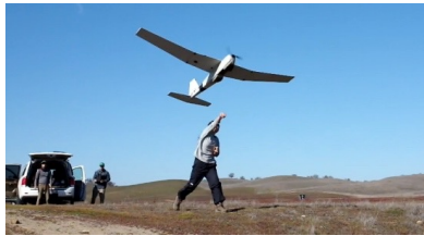
無線中継装置を搭載した無人航空機
