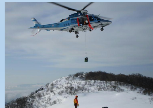
無線中継所停電に伴う警察ヘリを活用した資機材運搬
