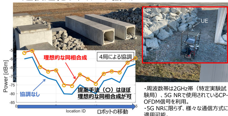
がれきエリアを走行するロボットの信号強度向上 (福島ロボットテストフィールド)
