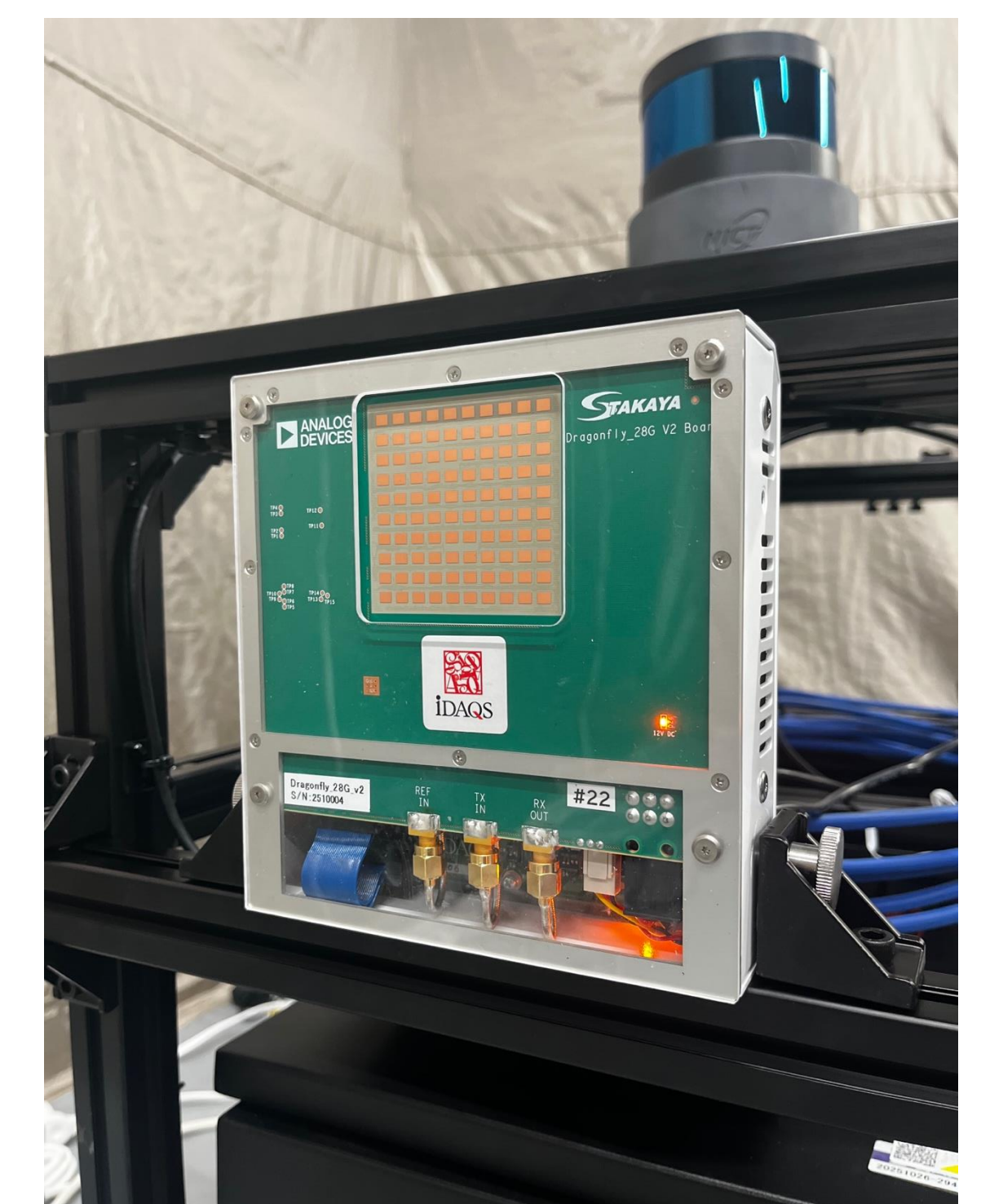
(d) 28GHz mmWave 8x8 phased array antenna module (Dragonfly)
