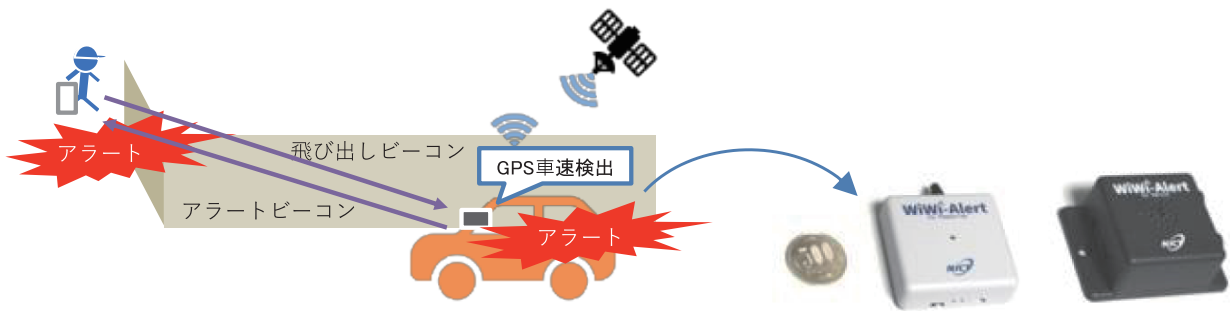
図3 GPSモジュールとWi-SUN通信機能を統合した交通安全システム(WiWi-Alert)
