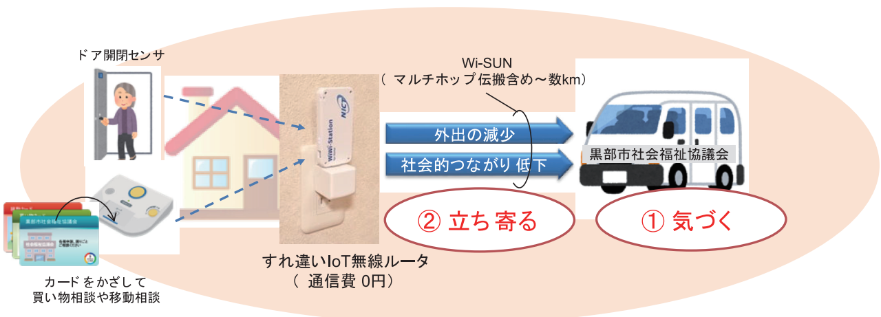
図4 “すれ違いIoT無線ルータ”搭載した地域車両で高齢者世帯の外出減少を“さりげなく”見守るサービス
