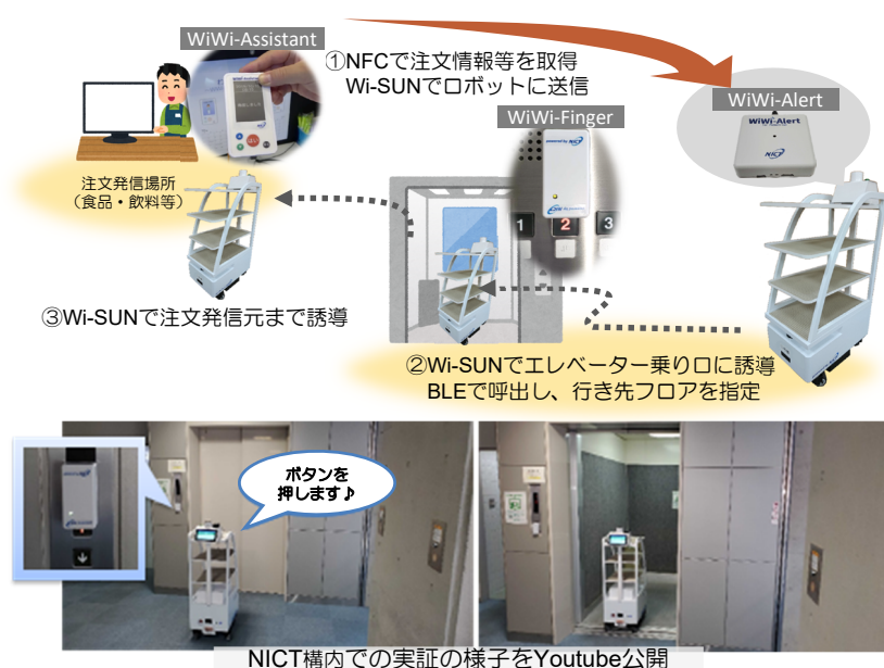
図1 人とロボットが共存・協働する構内空間で有効な近距離IoT無線を使ったフロア移動支援システムを開発
