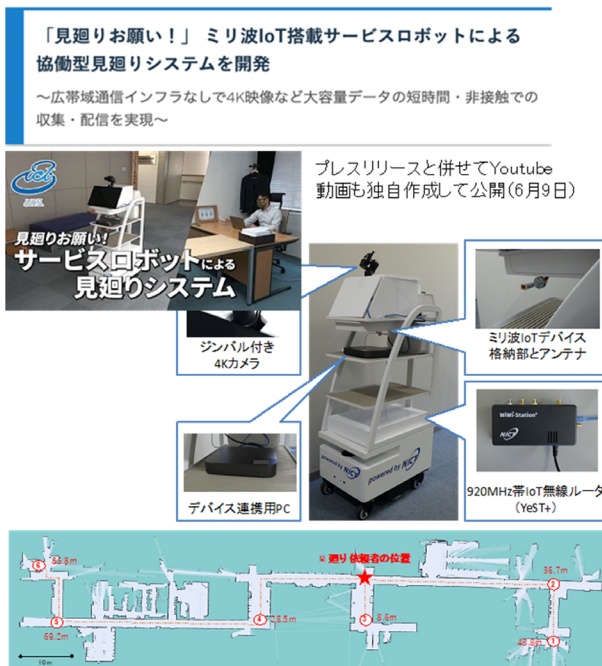
図1 ミリ波IoT搭載自律移動型サービスロボットによる協働型見廻りシステム
