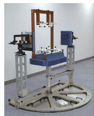
図4 THz帯伝搬特性測定装置
